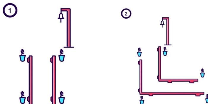
Препятствие состоит из коридора и стойки с закрепленным на ней колокольчиком. Коридор может быть прямым либо в форме буквы «L» с высотой бортов 0,3-0,6 м. Ширина прямого коридора 1,2 м, коридора углом – 1,5 м, длина одного сегмента коридора – 2 м.
