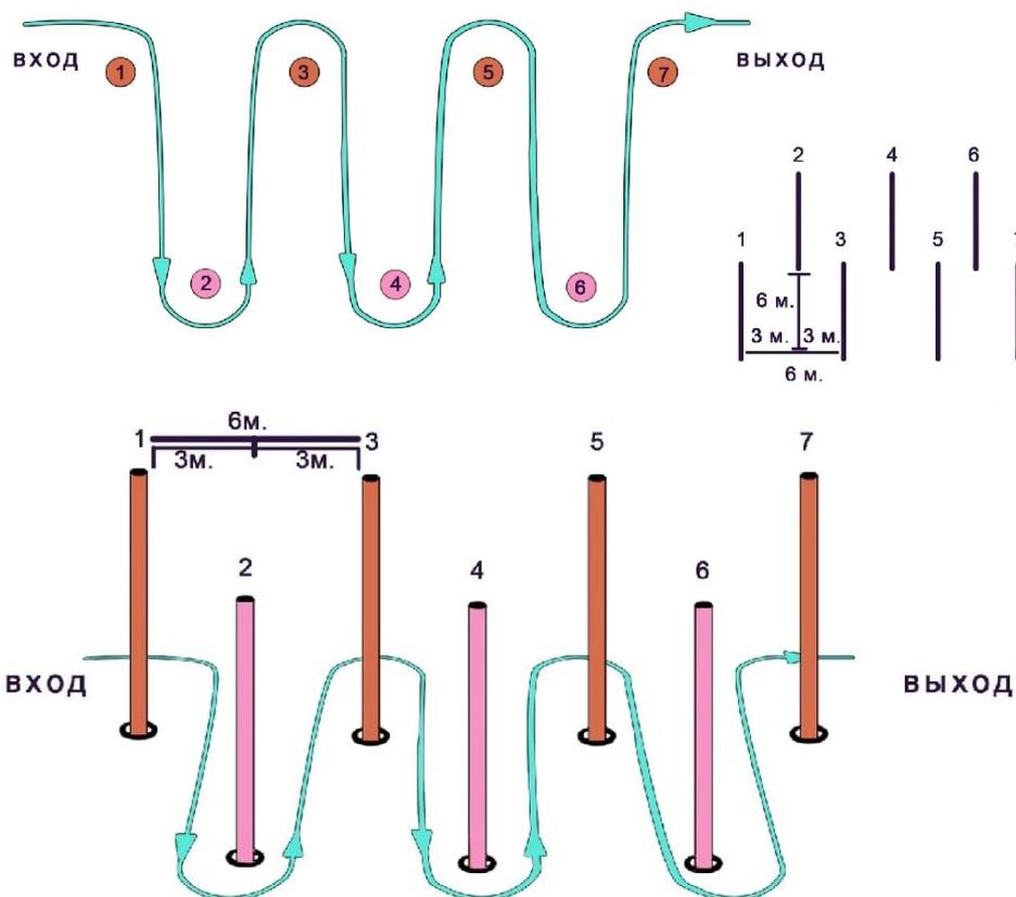
Препятствие представляет собой два параллельных ряда стоек высотой 2 м, расположенных на расстоянии 6 метров друг от друга. Общее количество стоек – 7.
